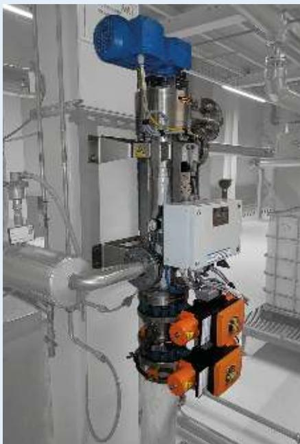
Q-Mag® entfernt automatisch Metallpartikel aus einem Medium. Das Medium bewegt sich spiralförmig um den Magneten herum, was die Wahrscheinlichkeit, dass Teilchen vom Magnetfeld angezogen werden, erheblich erhöht. Das Ergebnis ist eine äußerst effiziente Abscheidung selbst feinster magnetisierbarer Partikel.
